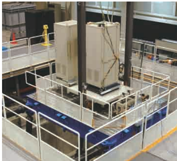
免震効果試験【株式会社 NTT ファシリティーズの三次元振動台で検証】
